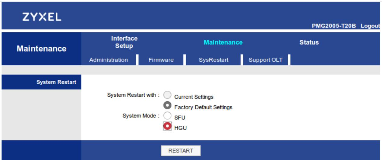
Após a ONU reiniciar novamente vamos marcar em Maintenance → SysRestart : **Factory Default Settings** : HGU **e não clicar** em RESTART
